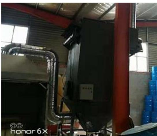
图4-5搅拌工序布袋除尘器
