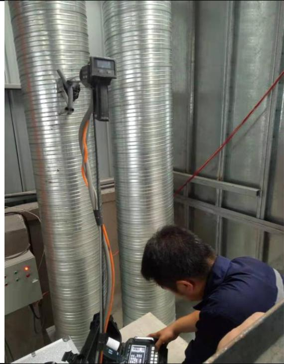
切割工序出口现场采样图
