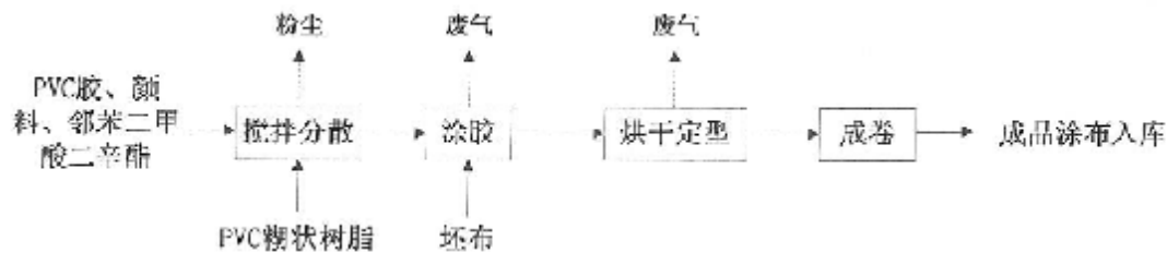
图 3-2 生产工艺流程及产污环节图
