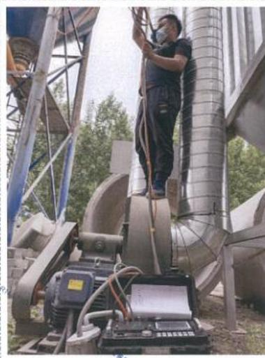
图 4 桥梁配料工序出口现场采样
