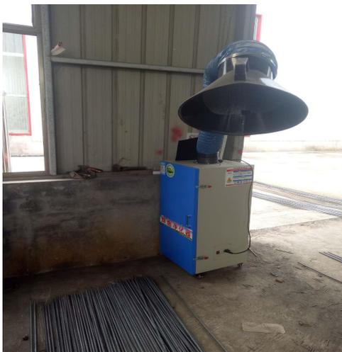
图 4-4 移动式焊烟净化器
