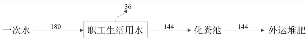
图 3-1 本项目水平衡图 单位:  $\text{m}^3/\text{a}$
