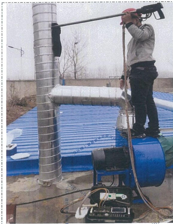
图 1: 厌氧池废气出口现场采样图
