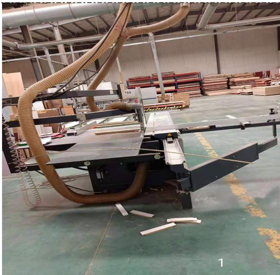
图 4-1 精密锯废气收集管道
