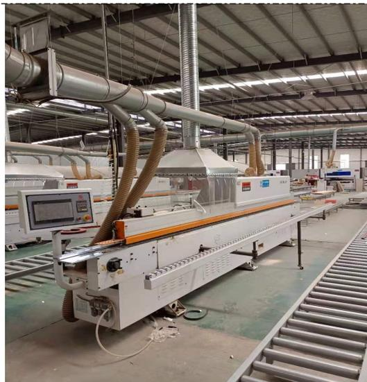
图 4-2 自动封边机废气收集管道
