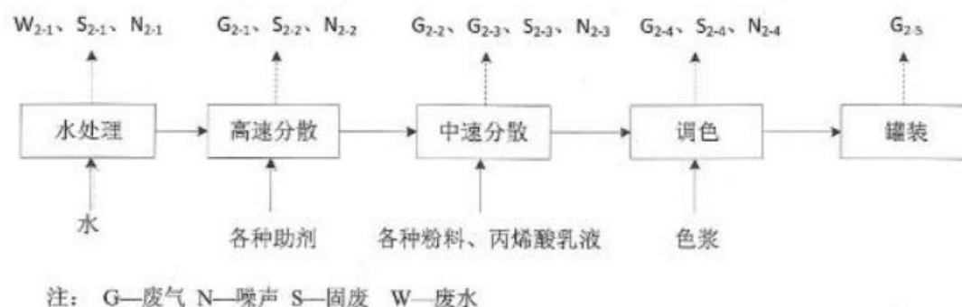
图 3-3 现有工程水性涂料工艺流程及产污环节图
