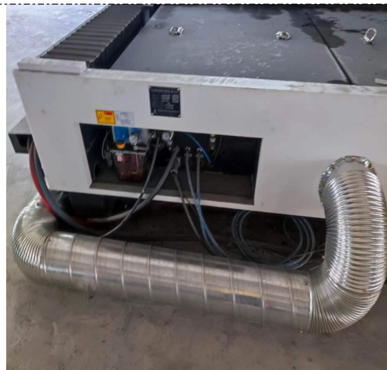
切割烟尘废气收集管道
