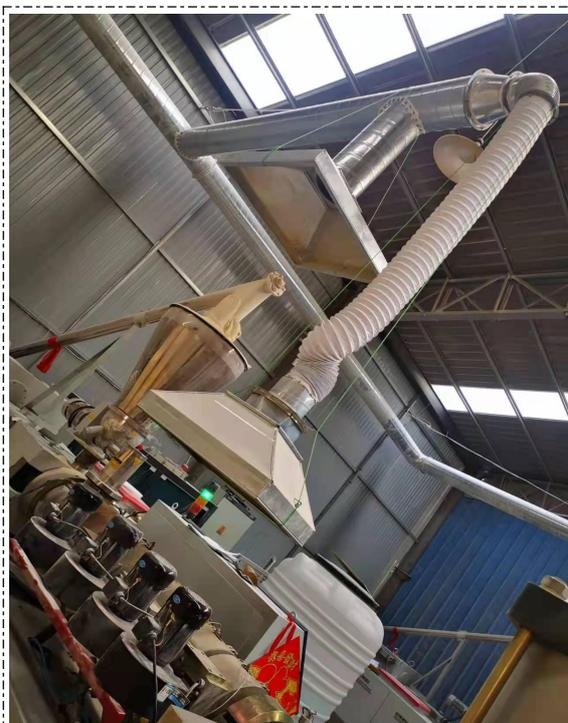
图 4.1-1 挤出工序集气罩
