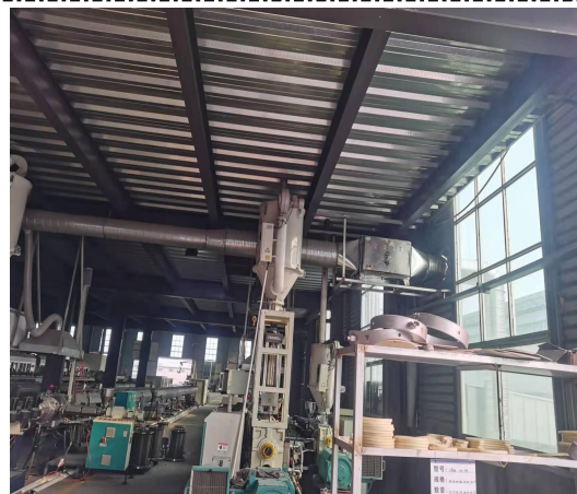
2#生产车间 PE 管挤出废气处理设施（静电除油）
