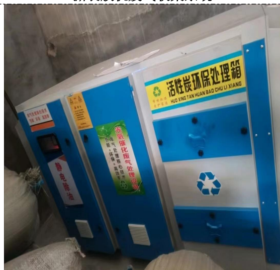
有机废气处理设备（静电除油+光催化氧化+活性炭吸附）
