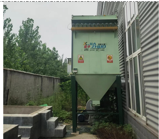
切割、焊接、刷光工序环保处理设备 (脉冲布袋除尘器)
