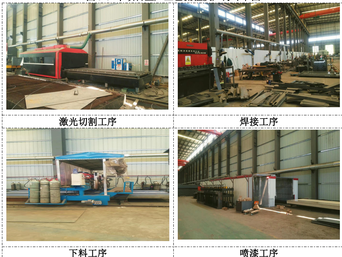
图 3-5 本项目生产工艺流程及产污环节图
