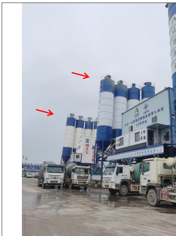
水泥筒仓顶部除尘器
