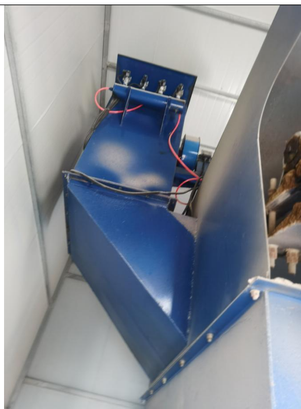
搅拌机除尘器
