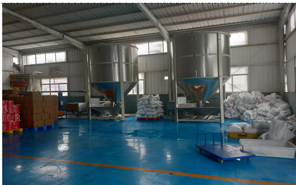
图 3-9 投料搅拌上料系统
