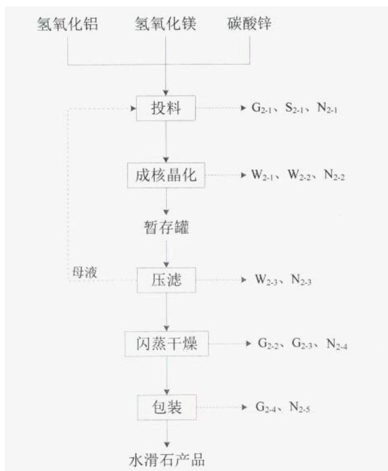
图 3-5 本项目水滑石生产工艺及产污环节图
