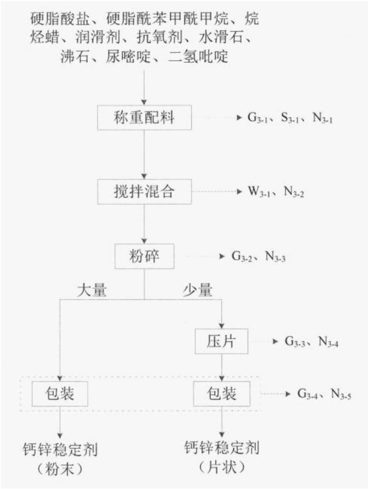
图 3-6 本项目水滑石生产工艺及产污环节图
